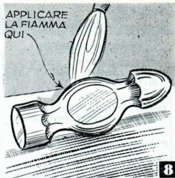
**8** Per temperare le testate di un martello il riscaldamento va applicato secondo la direzione delle frecce. Dovendolo indurire prima di temperarlo si abbia l'avvertenza di riempirne la cavità per il manico con argilla.
