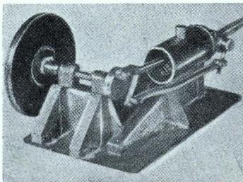
**La foto del motore, visto dalla parte posteriore, mostra le bronzine saldate sui supporti in lamierino, anche sottile. Il pezzo di tubo di ottone, saldato sul cilindro è un oliatore il cui scopo è quello di ridurre l'attrito tra il pistone ed il cilindro. Le altre parti in movimento vanno lubrificate con grasso minerale.**
