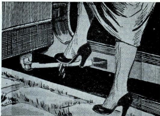
Un'asticella di metallo che consenta, ad apertura dello sportello della macchina, di raschiare dalle scarpe il fango e la terra appiccicata alle suole. L'interno della macchina sarebbe sempre più pulito.
