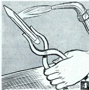
**4** Riscaldamento con fiamma diretta, di uno scalpello, per indurirlo o temperarlo. Applicando la fiamma un poco al di dietro della punta si permette alla temperatura di avanzare uniformemente verso la punta stessa.
