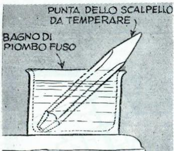
**5** Riscaldando il fusto degli utensili nel bagno di piombo fuso nel modo indicato si riesce a controllare accuratamente il colore della punta da trattare.
