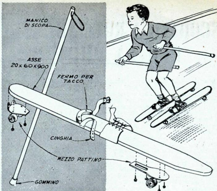
rete a due manici di scopa; ad una estremità di ognuno di essi infilate un cappuccio di gomma, di quelli usati per le grucce; all'altra estremità, che forerete, fate passare un anello di funicella robusta, oppure di striscia di cuoio.
