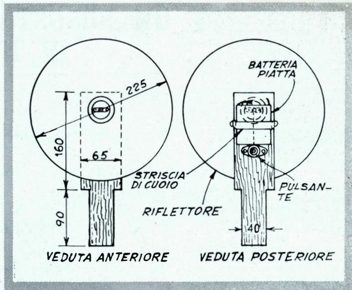
te al terminale del portalampane, rimasto libero. Come si vede, necessitano soltanto tre pezzetti di filo e, ad ogni terminale della batteria, portalampane e pulsante, fa capo un solo filo. Per permettere una più agevole sostituzione della batteria, si può ricorrere a terminali muniti di morsetto, invece che saldati.
