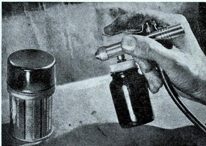
Questo utensile è presso a poco la via di mezzo tra un aerografo ed una normale pistola a spruzzo. Può essere usato con ogni tipo di smalto o vernice, purché adeguatamente diluita. Utilissimo per il ritocco.
