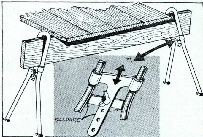
male verticale in posizione inclinata, cosicché la trave viene saldamente tenuta. Ne risulta una unione solida dei sostegni e delle travi, unione che risulta ancora rinforzata tanto dal peso proprio della trave quanto dagli assi del cavalletto dopo il loro caricamento. Per il montaggio del cavalletto, i due sostegni ven-
