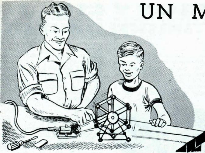
**E'** sempre interessante costruire qualcosa che « giri ». Questo motorino a vapore possiede un notevole spunto ed offre inoltre una visione realistica di funzionamento. Collegato ad una caldaia, ad una pompa da bicicletta, ad una bombola di aria compressa, ad un compressore, ecc. potrà azionare un modello od anche una piccola dinamo, senza difficoltà.
