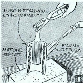
**1** Per il trattamento termico di piccoli oggetti. Una piccola punta di acciaio da utensili può essere riscaldata tenendola in un pezzo di tubo dal diam. interno leggermente superiore al pezzo da trattare e muovendo continuamente la fiamma su detto tubo per permettere una uniforme distribuzione del calore.
