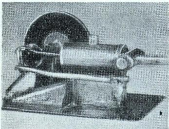
**Il movimento oscillante per l'azionamento del distributore è prodotto da una spina appositamente fissata sull'eccentrico ad un angolo di 90° rispetto alla spina della biella del pistone. Il tubetto di ammissione può essere collegato ad un generatore di vapore o di aria compressa, per mezzo di un tubo di gomma.**
