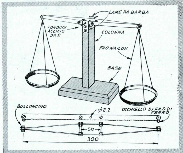
tempera delle lame, disponendole, ad esempio, su di una fiamma a gas, e poi, quando esse hanno raggiunto la temperatura corrispondente al calore rosso scuro, spegnere la fiamma e lasciate raffreddare più lentamente possibile le lame.
