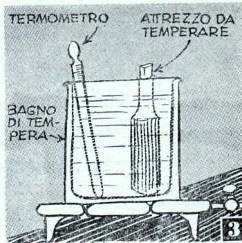
**3** Tempera della punta di acciaio in un bagno di sale o di piombo fuso. Il termometro ad immersione permette un preciso controllo della temperatura.
